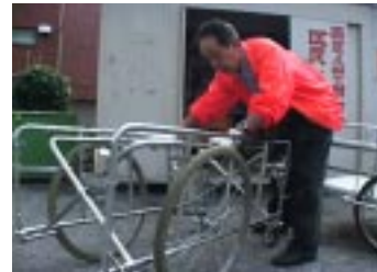
写真：リアカー担架 普段は折り畳める
